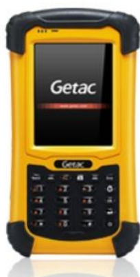
Figure 17 : Photo du terminal GPS GETAC PS 236
