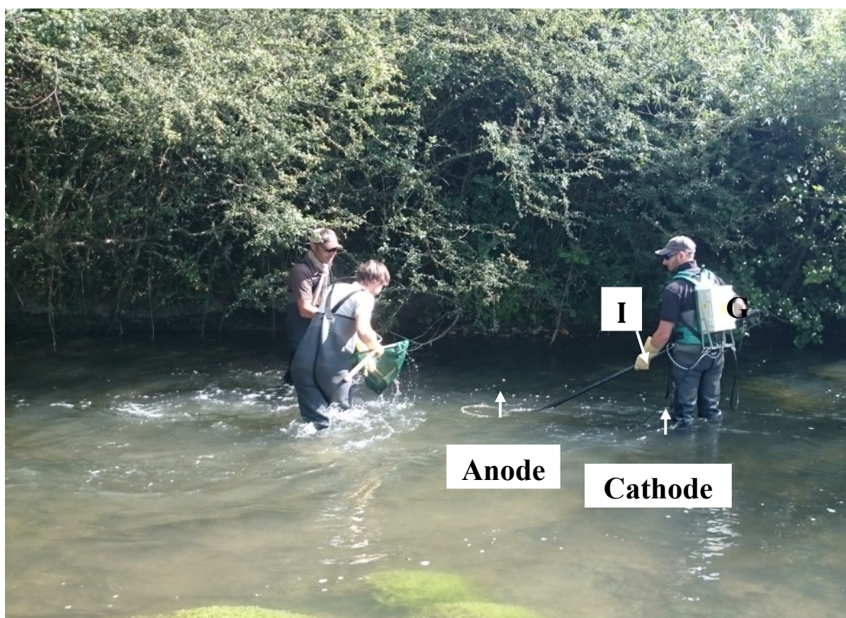
Figure 18 : Photo annotée d'une pêche à l'électricité (A. Barault, M. Bonnet, V. Zunigas) (FDAAPPMA27)
